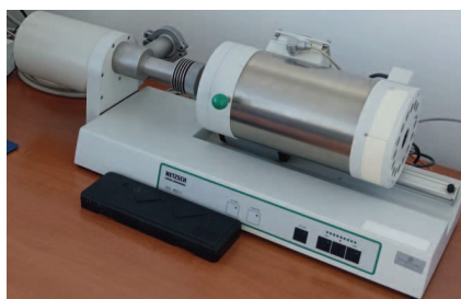
FIGURA 8. Dilatómetro Netzsch modelo DIL 402 C
