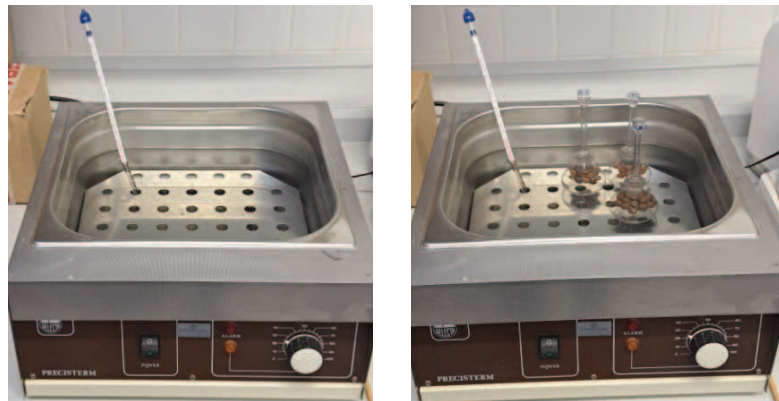
FIGURA 18. Baño termostático Precistern
