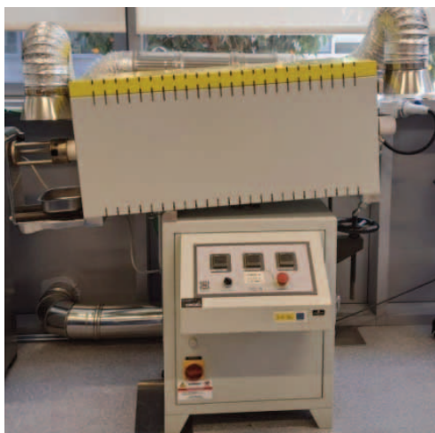
FIGURA 15. Horno tubular rotativo Nannetti® TOR-R 120-14
